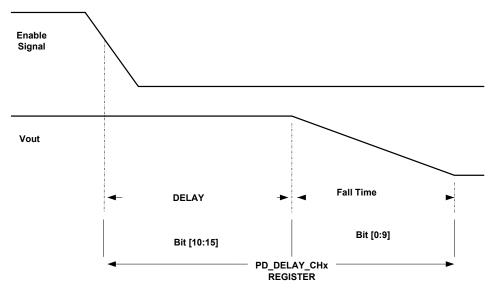
Fig. 25: Channel Soft-Stop Sequence
