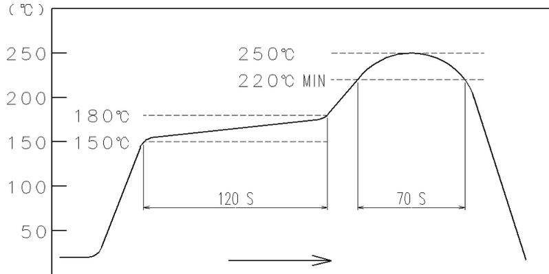
**FIG - 1 RESISTANCE TO SOLDERING HEAT**
