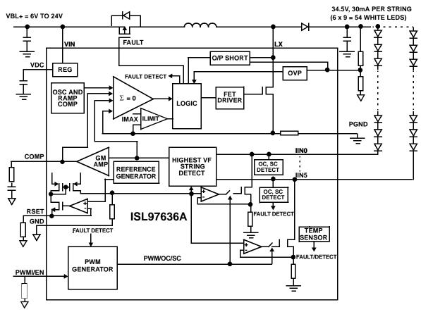
FIGURE 1. ISL97636A BLOCK DIAGRAM
