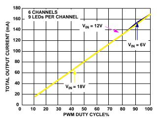
FIGURE 8. PWM DIMMING LINEARITY
