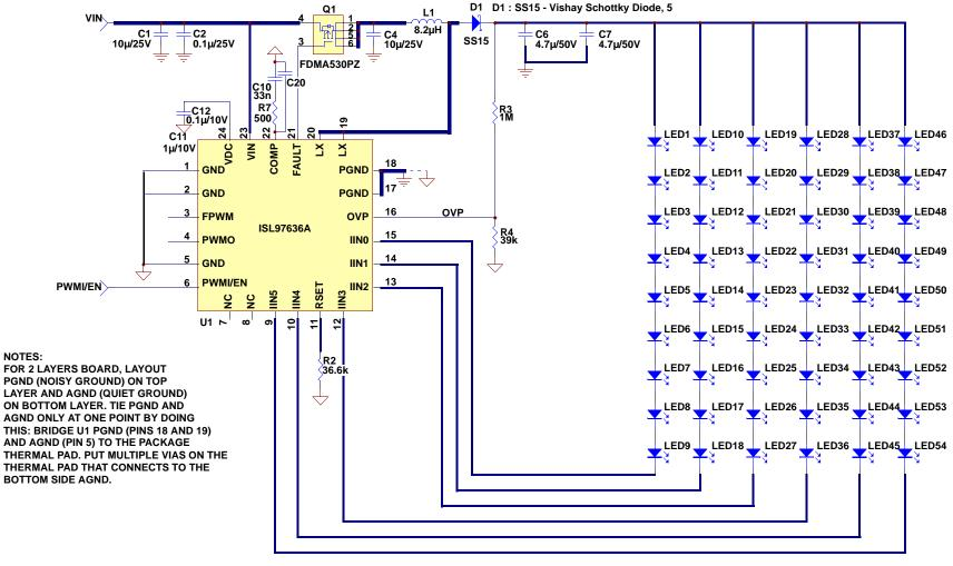
FIGURE 20. TYPICAL APPLICATION CIRCUIT
