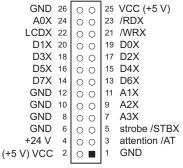
Figure E-1. PLCBus Pin Diagram
