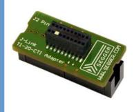
TMS TRST TDI GND **VTref** 5 ♦ 6 NC TDO 7 • • 8 GND RTCK 9 • • 10 GND TCK 11 • • 12 GND **EMUO** 13 • • 14 EMU1 NSRST 15 ♦ ♦ 16 GND NC 17 • • 18 NC NC 19 • • 20 GND
