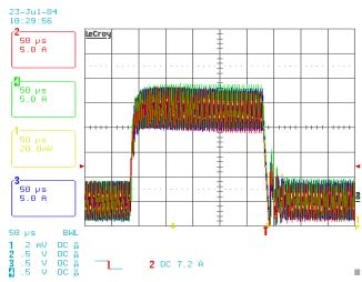
FIGURE 20. TRANSIENT LOAD 3 PHASE OPERATION - CURRENT BALANCE
