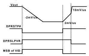
FIGURE 43. DEEPER SLEEP TRANSITION SHOWING DPRSLPVR'S EFFECT ON EXIT SLEW RATE
