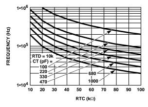
FIGURE 4. CAPACITANCE vs FREQUENCY
