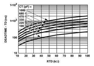
FIGURE 3. DEADTIME (DT) vs CAPACITANCE
