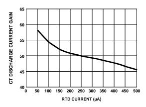
FIGURE 2. OSCILLATOR CT DISCHARGE CURRENT GAIN
