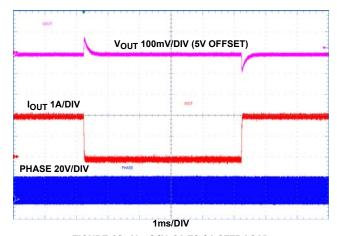
FIGURE 13.  $V_{\text{IN}}$  24V, 0A TO 2A STEP LOAD
