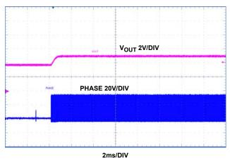
FIGURE 9. V<sub>IN</sub> 36V, PRE-BIASED START-UP
