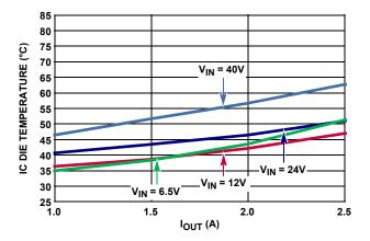
FIGURE 8. IC DIE TEMPERATURE UNDER +25°C AMBIENT TEMPERATURE, STILL AIR, 500kHz, V<sub>OUT</sub> = 5V
