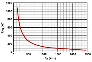
FIGURE 16. RES VS FREQUENCY
