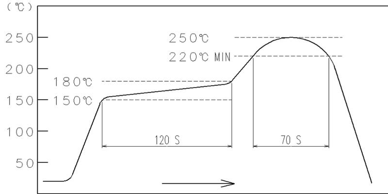
**FIG - 1 RESISTANCE TO SOLDERING HEAT**
