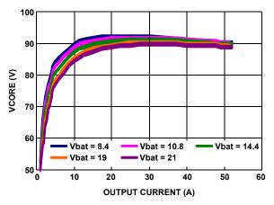
FIGURE 9. ISL6244 EFFICIENCY vs LOAD
