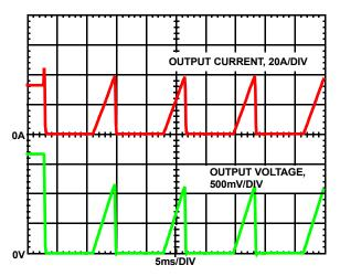
FIGURE 24. OVERCURRENT BEHAVIOR IN HICCUP MODE
