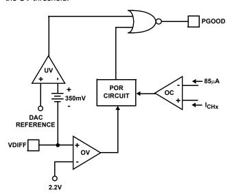
FIGURE 23. POWER GOOD AND PROTECTION CIRCUITRY
