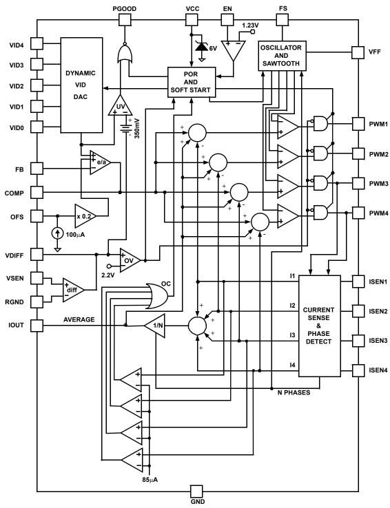
FIGURE 12. BLOCK DIAGRAM
