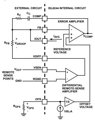
FIGURE 17. OUTPUT-VOLTAGE AND LOAD-LINE REGULATION
