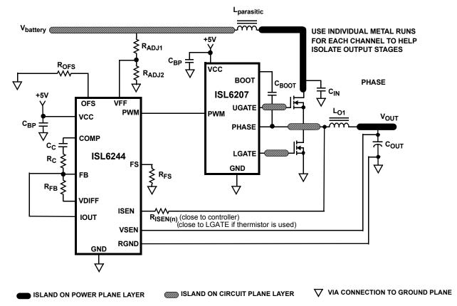
FIGURE 32. PRINTED CIRCUIT BOARD POWER PLANES AND ISLANDS
