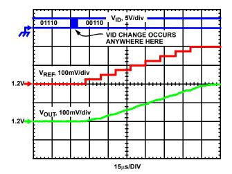
FIGURE 19. DYNAMIC-VID WAVEFORMS FOR 250kHz ISL6244
