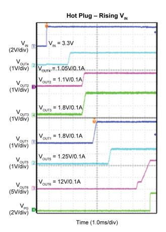
Figure 15. Hot Plug - V<sub>IN</sub> Rising
