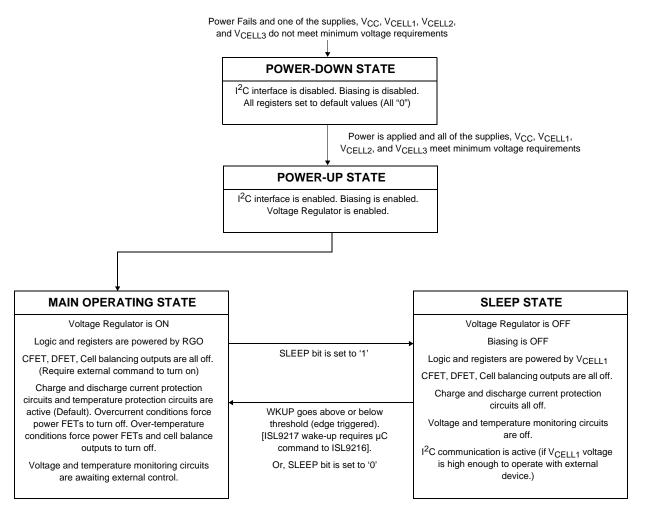
FIGURE 16. DEVICE OPERATION STATE MACHINE
