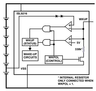
FIGURE 3. WAKE-UP CONTROL CIRCUITS
