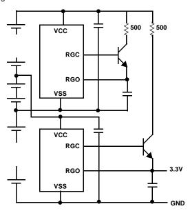
FIGURE 2. VOLTAGE REGULATOR CIRCUITS
