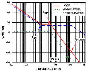
FIGURE 24. CHARGE CURRENT LOOP BODE PLOTS
