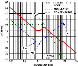
FIGURE 22. ASYMPTOTIC BODE PLOT OF THE MAX SYSTEM VOLTAGE CONTROL LOOP GAIN
