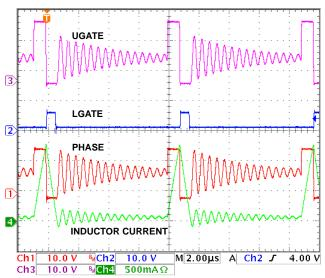
FIGURE 13. 100kHz SWITCHING WAVEFORMS
