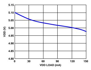
FIGURE 7. VDD LOAD REGULATION
