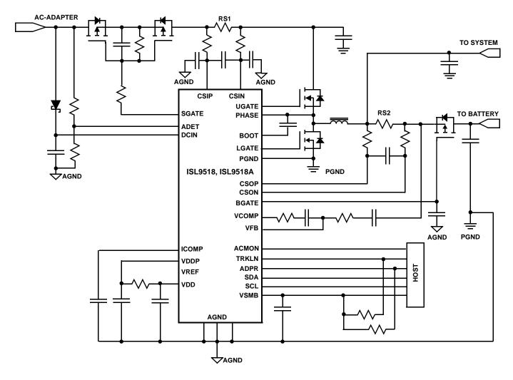
FIGURE 2. TYPICAL APPLICATION CIRCUIT
