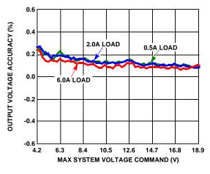
FIGURE 3. MAXIMUM SYSTEM VOLTAGE ACCURACY
