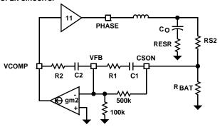
FIGURE 21. MAX SYSTEM VOLTAGE LOOP COMPENSATOR
