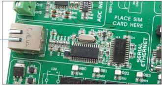
Figure 8-1: Ethernet module
