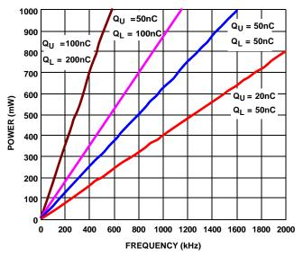
FIGURE 6. POWER DISSIPATION vs FREQUENCY
