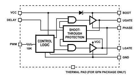
FIGURE 1. BLOCK DIAGRAM
