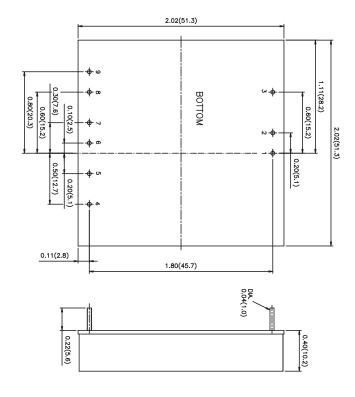
ALL DIMENSIONS IN INCHES(mm) PIN PITCH TOLERANCE  $\pm 0.014(0.35)$  Tolerance :  $x.xx\pm0.02(x.x\pm0.5)$   $x.xxx\pm0.01(x.xx\pm0.25)$
