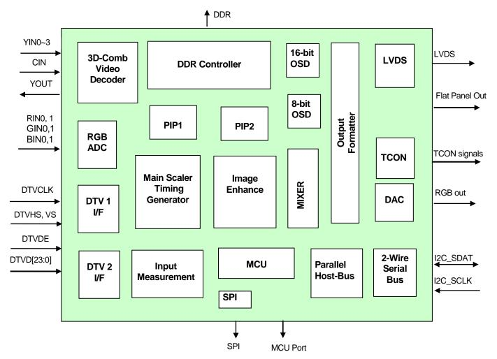
FIGURE 1. TW8823C FLAT PANEL TV/MONITOR CONTROLLER FUNCTIONAL BLOCK DIAGRAM
