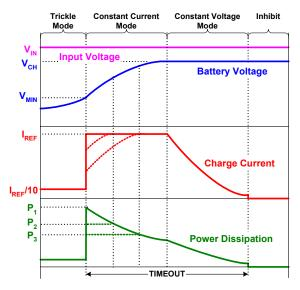
FIGURE 3. TYPICAL CHARGE CURVES USING A CONSTANT-VOLTAGE ADAPTER
