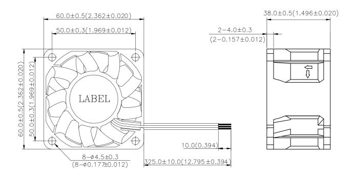
UNIT: mm (INCH) UL 1007 -F- AWG #24 BLACK WIRE NEGATIVE(-)RED WIRE POSITIVE(+) BLUE WIRE FREQUENCY(-F00)
