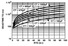
FIGURE 3. DEADTIME (DT) vs CAPACITANCE
