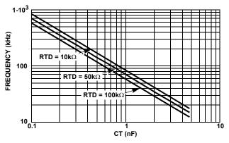
FIGURE 4. CAPACITANCE vs FREQUENCY
