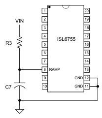
FIGURE 9. VOLTAGE FEED FORWARD CONTROL
