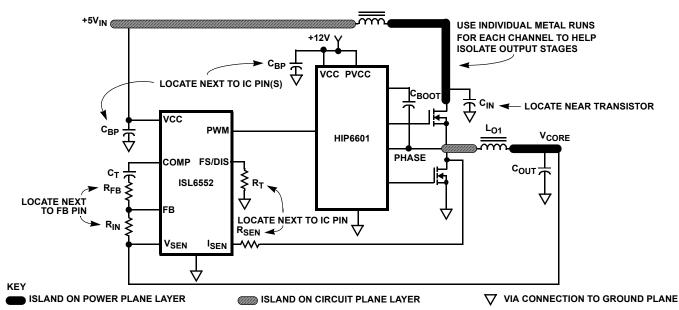
FIGURE 12. PRINTED CIRCUIT BOARD POWER PLANES AND ISLANDS
