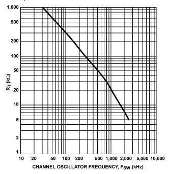
FIGURE 10. RESISTANCE RT vs FREQUENCY
