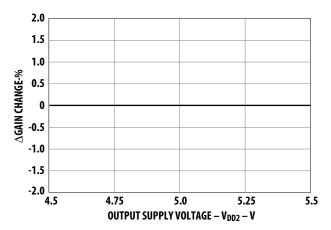
Figure 9. Gain change vs.  $V_{\rm DD2}$ .
