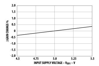
Figure 8. Gain change vs.  $V_{\rm DD1}$ .
