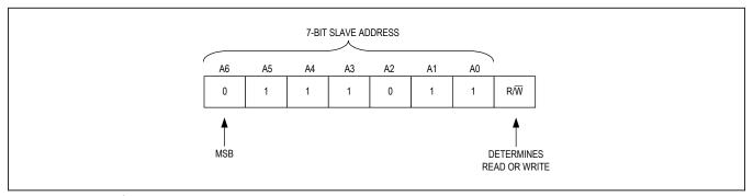
Figure 42. DS2476 I<sup>2</sup>C Slave Address
