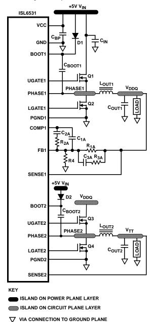
FIGURE 7. PRINTED CIRCUIT BOARD POWER PLANES AND ISLANDS
