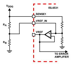
FIGURE 4. V<sub>TT</sub> REFERENCE OVERDRIVE
