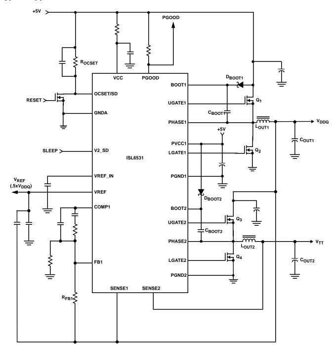
FIGURE 1. TYPICAL APPLICATION FOR ISL6531
