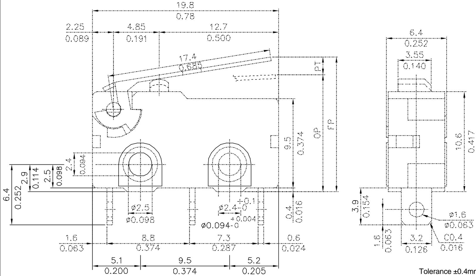
Tolerance  $\pm 0.4\text{mm}$
