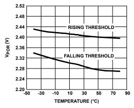
FIGURE 10.  $V_{\mbox{POR}}$  vs TEMPERATURE
