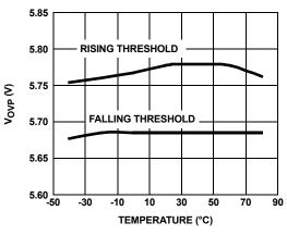
FIGURE 11. INPUT OVERVOLTAGE PROTECTION vs TEMPERATURE
