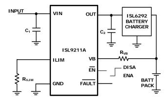
FIGURE 1. TYPICAL APPLICATION CIRCUIT
