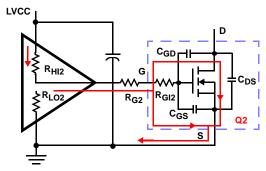
FIGURE 4. TYPICAL LOWER-GATE DRIVE TURN-ON PATH
