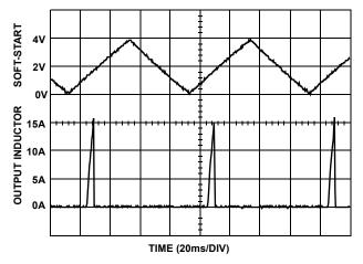
FIGURE 4. OVER-CURRENT OPERATION
