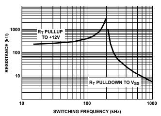
FIGURE 1. RT RESISTANCE vs FREQUENCY
