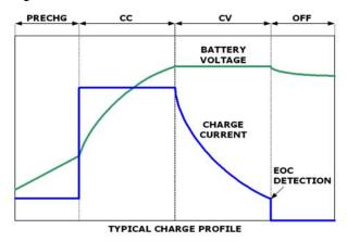
FIGURE 1. TYPICAL CHARGE PROFILE
